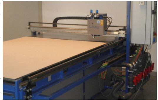
CUTTER 2015 mit S-TANG Schneidekopf beim ziehenden Schneiden von Carbon (Prepreg 8-lagig).
