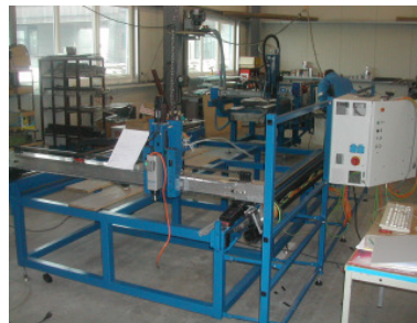
Grundgestell mit Querbalken, ohne Tisch und Abdeckungen
