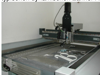
Erster Prototyp mit Oberfräse als Frässpindel
